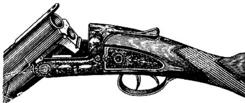
Рис. 55. Двуствольное ружье с вертикально спаренными стволами
