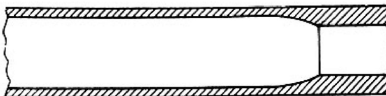
Рис. 56. Разрез ствола с чоковой сверловкой
